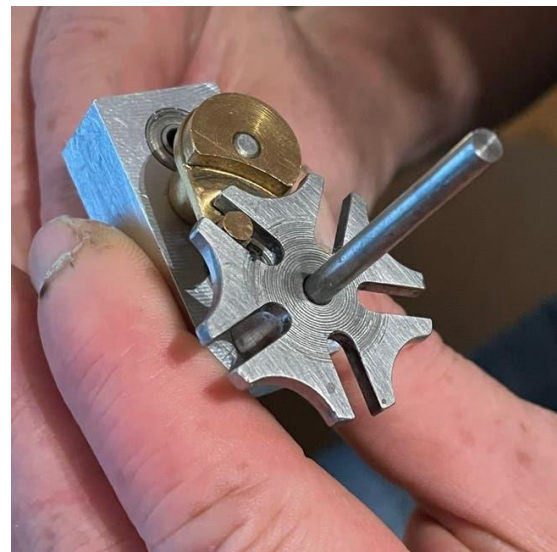
Das Schrittgetriebe transportiert schrittweise das Filmmaterial. Bild: Zita Meienhofer
